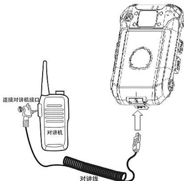
对讲机和执法仪连接示意图
